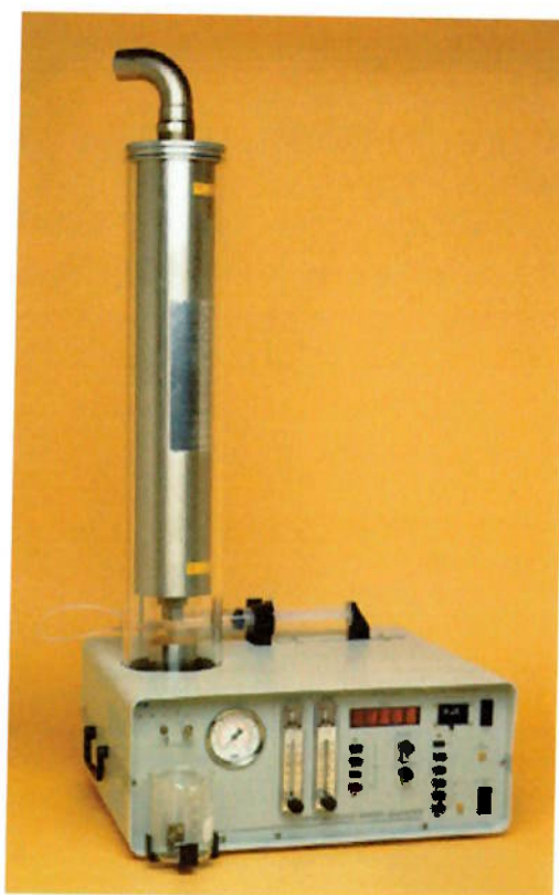
Figura 39 Foto do gerador de partículas por orifício vibrante
