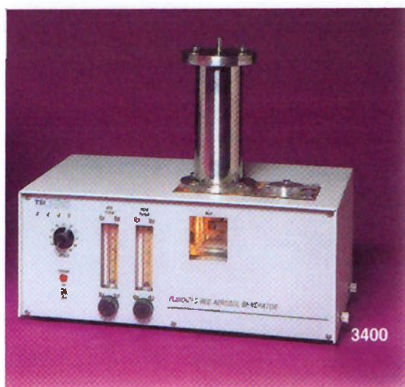
Figura 32 Foto do gerador de aerossol por leito fluidizado
