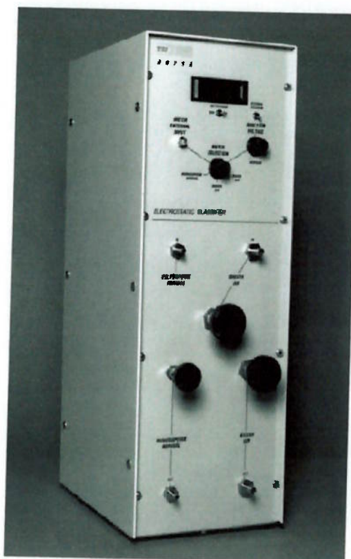
Figura 28 Foto do classificador eletrostático
